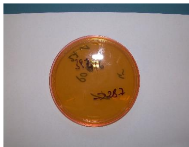
Sedimentationsplatte/Luftkeimbestimmung Hefe- und Schimmelpilze (Sabouraud)
