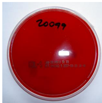
Sedimentationsplatte/ Luftkeimbestimmung Gesamtkeimzahl (Columbia-Agar mit 5% Schafblut)
